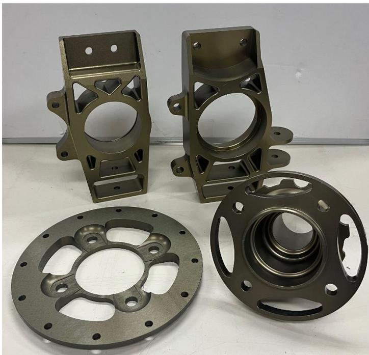
図 6. 硬質アルマイト加工していただいたアップライト・ハブ
