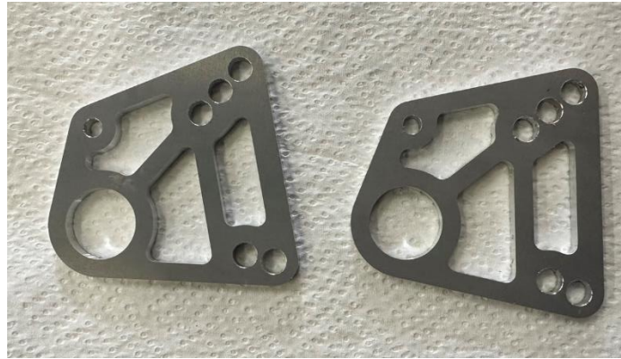
図 11. 完成したベルクランク
