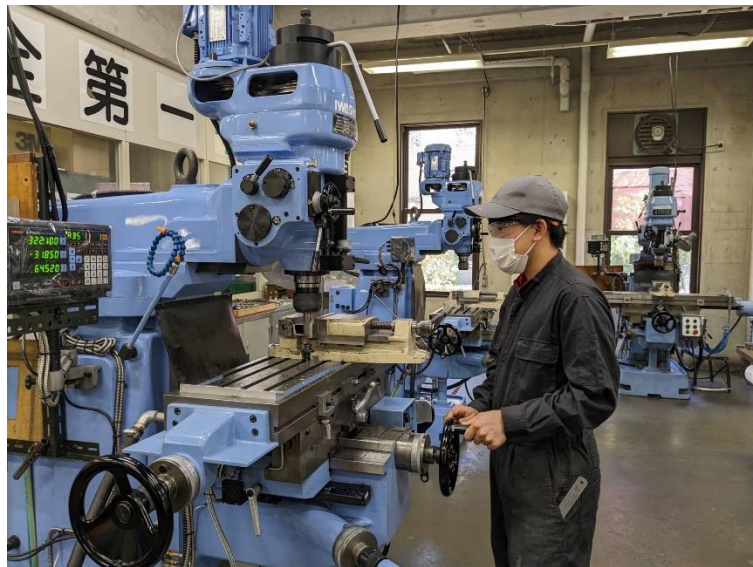
図 12. フライス盤を使用して端面処理をする様子
