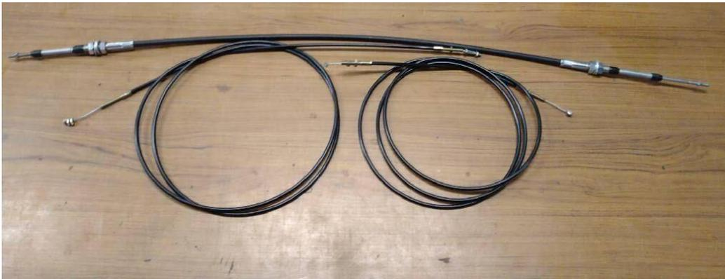
図 5. 提供していただいたシフターケーブル、クラッチケーブル、スロットルケーブル
