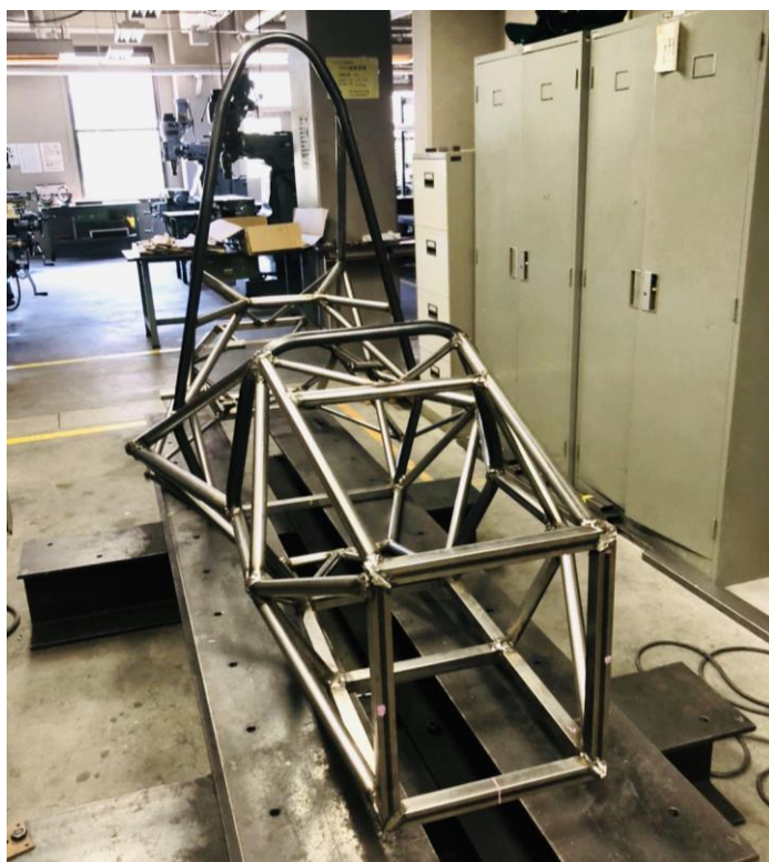
図1 20年度車両のフレームの様子
