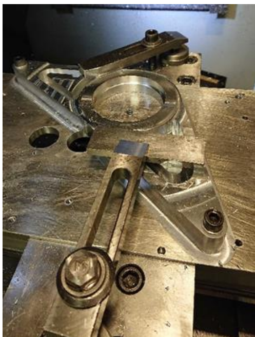
図6 ディファレンシャルマウント製作の様子
