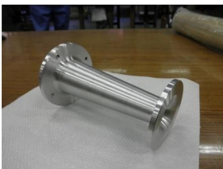
図 10 完成したリストラクター
